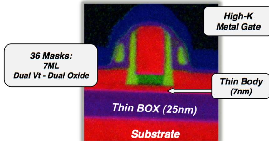
$L_g=24$  nm,  $T_{ox}=1.8$  nm,  $V_{sup}=1.0$  V
