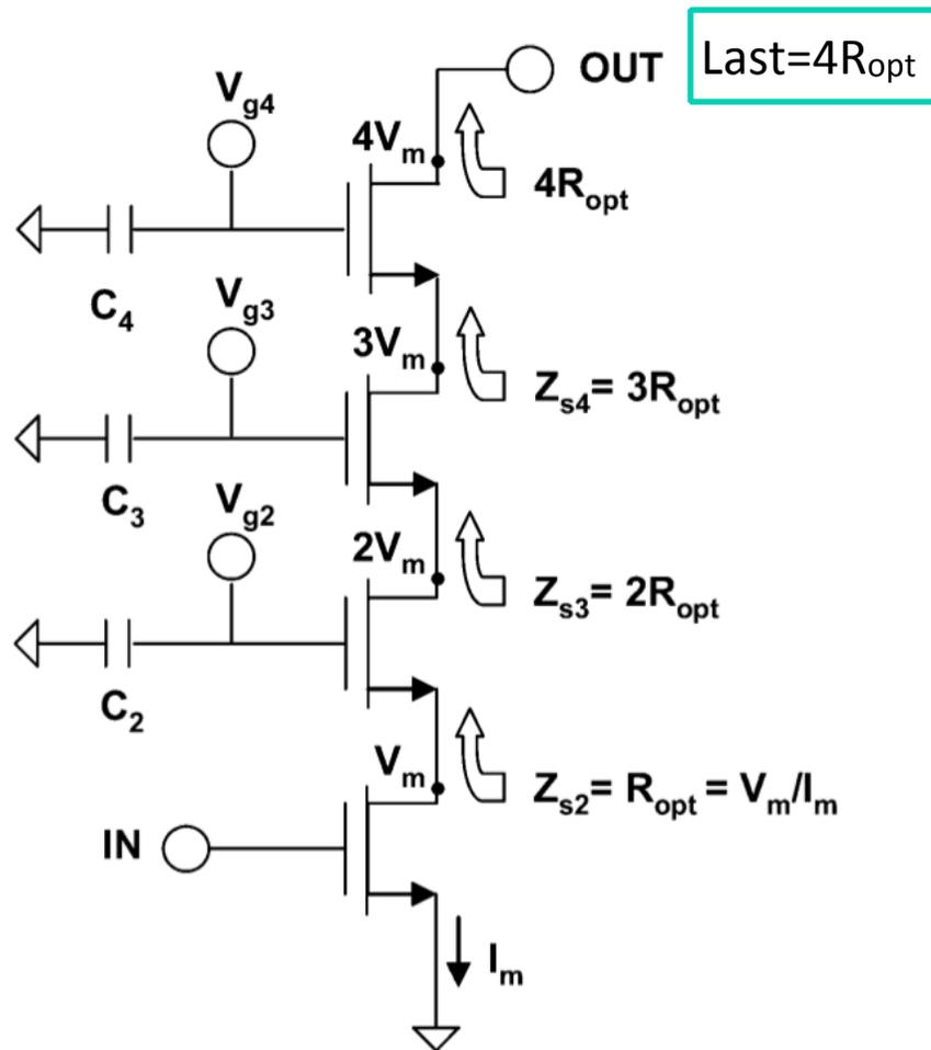
$C_2, C_3, C_4$  set  $Z_{s2}, Z_{s3}, Z_{s4}$
